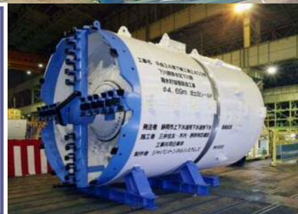
貯留管を作る掘削機械（シールドマシン）
