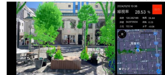
図 AIを用いた都市の緑視率のモニタリング(青葉緑地) (国土交通省 国土技術政策総合研究所のAI緑視率調査プログラムを利用)
