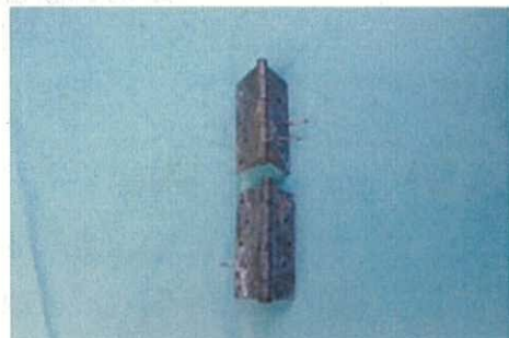
写真 30 蝶番の焼損の状況
