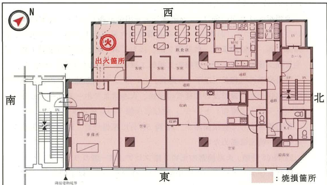
図4 焼損状況及び出火箇所
