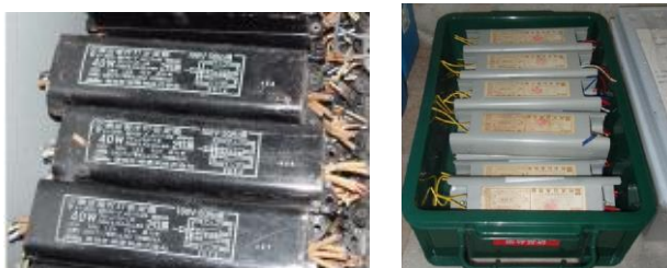
【安定器の保管例】
